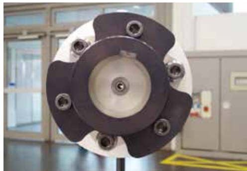
Die Besonderheit dieser LP-Kupplung besteht in der Bohrung in der Mitte: Durch dieses Innenrohr kann Kühlschmiermittel bei langen Spindeln direkt in das Werkzeug geführt werden.
